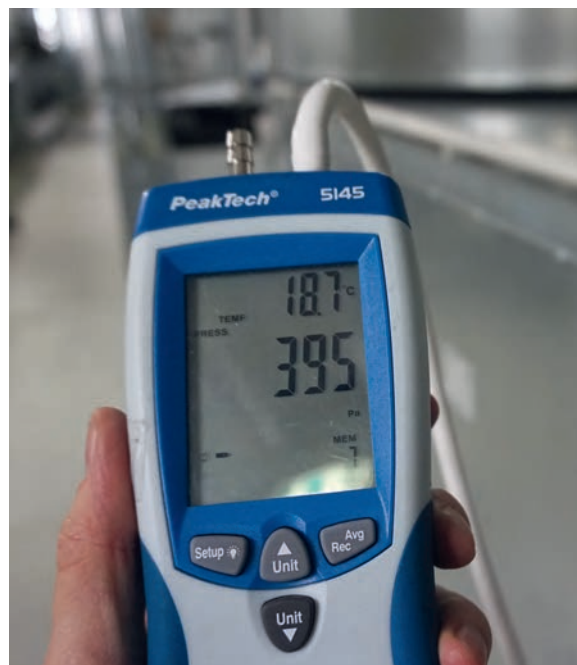
▲ Messung der statischen Druckerhöhung eines Ventilators.
